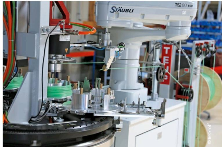
Der zentrale Schaltschrank-Industrie-PC C6930 steuert alle Maschinenfunktionen, XTS und über TwinCAT Robotics uniVAL PLC auch zwei Stäubli-Roboter.
