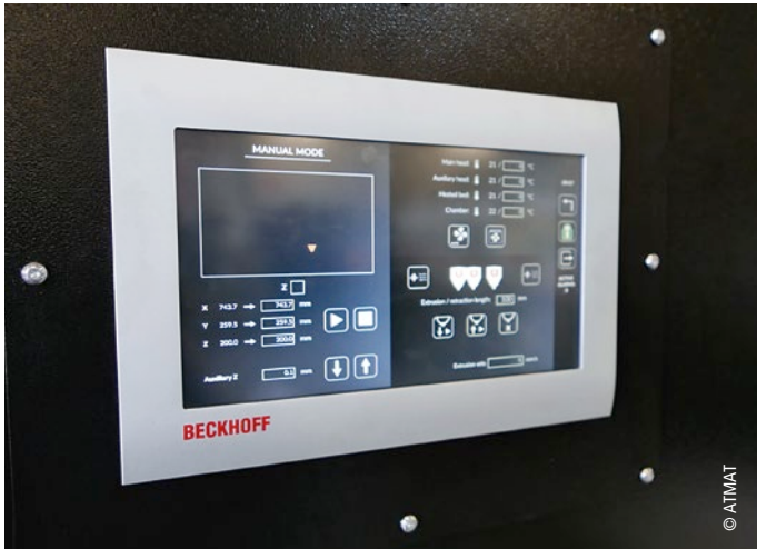
Der integrierte Panel-PC CP6700 mit TwinCAT HMI ermöglicht eine komfortable Bedienung des 3D-Druckers.
