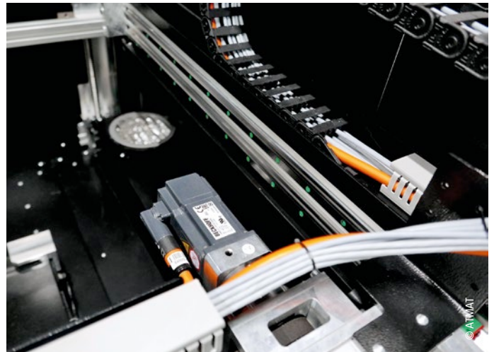
Beckhoff-Servomotoren AM8121 ergeben in Kombination mit den Servomotorklemmen EL72xx hohe Geschwindigkeit und Präzision bei der Bewegung der Druckköpfe.
