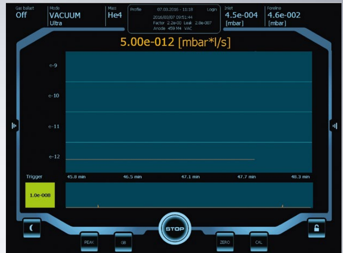
Das übersichtliche User-Interface des Leckdetektors ist mit TwinCAT 3 PLC HMI realisiert.
